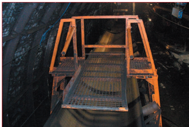
Rys. 1 Pomost typu 21-103 do wsiadania ludzi na górną taśmę przenośnika
