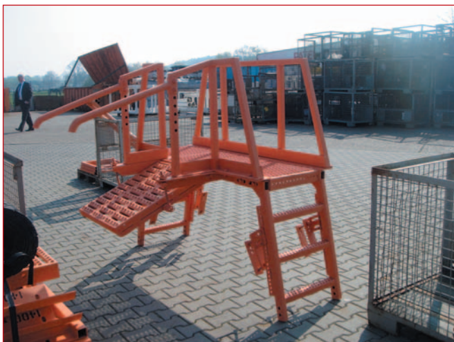
Rys. 2 Pomost typu 21-103.2 do wsiadania ludzi na taśmę przenośnika
