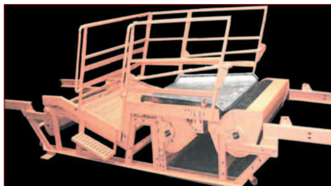
Rys. 5 Urządzenie typu 21-108.21 do wysiadania z dolnej taśmy z pozycji siedzącej
